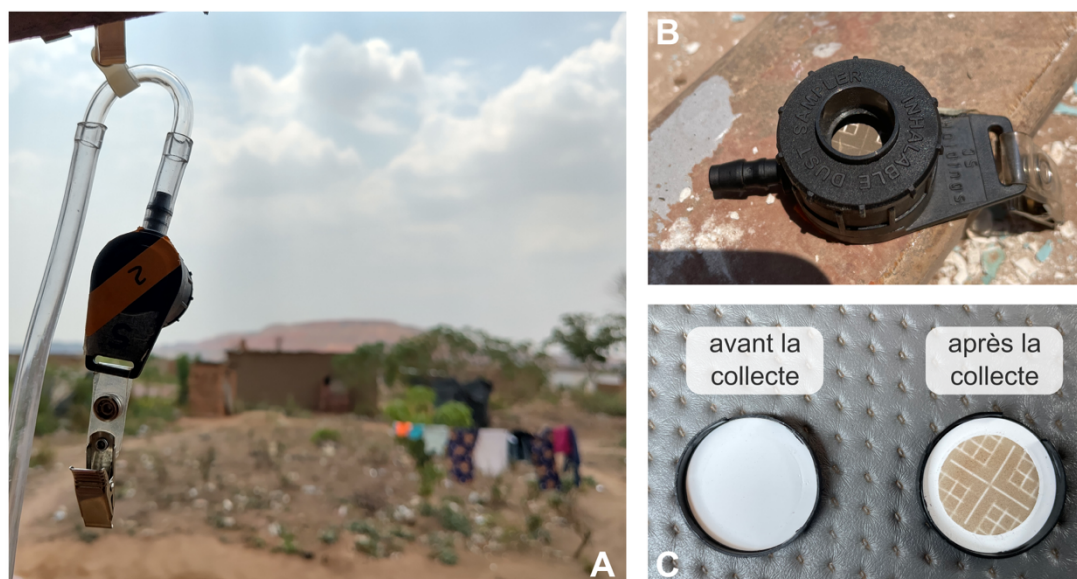
Figure 5. Détails de l'échantillonneur IOM pour la collecte des poussières inhalables. Nous plaçons l'échantillonneur contenant un filtre propre face aux sources potentielles de poussières (A). Après la collecte, nous le récupérons (B) et en extrayons le filtre, qui était toujours nettement plus foncé qu'avant la collecte (C).
