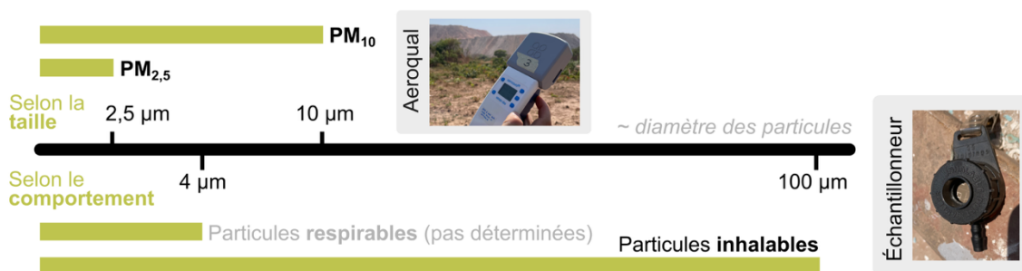
Figure 2. Aperçu des paramètres surveillés dans cette étude. La définition de « PM 2,5 » et « PM 10 » (en haut) repose sur la taille des particules, tandis que les termes « respirables » et « inhalables » (en bas) renvoient au comportement des particules dans le système respiratoire : la fraction inhalable n'atteint que la bouche et le nez, tandis que la fraction respirable pénètre profondément dans les poumons. Nous avons mesuré les PM 10 et les PM 2,5 avec un appareil Aeroqual, tandis que les particules inhalables ont été collectées à l'aide d'un échantillonneur actif et envoyées à un laboratoire accrédité pour la quantification des métaux lourds (détails supplémentaires dans la section Sites et méthodes d'échantillonnage ).
